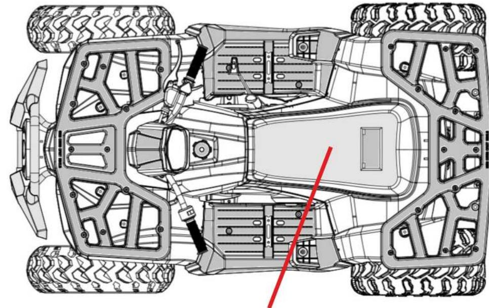
Расположение главного предохранителя
